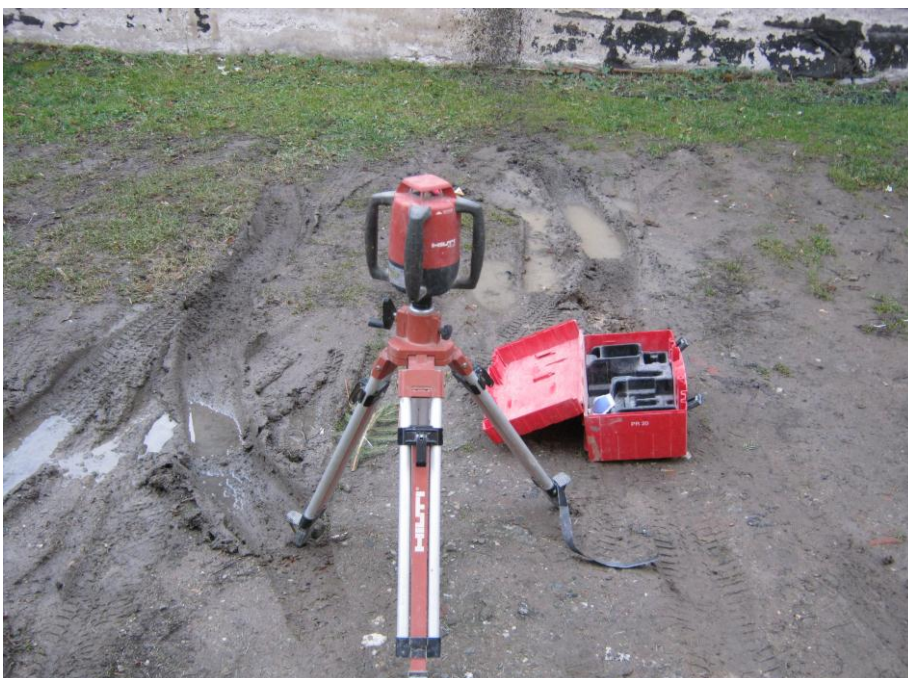
Obr. č. 1: Nivelační laser
