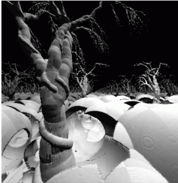
Obr.2 Voxelový model terénu, který je složeným tělesem, byly od něj odečteny různé velikosti koulí. Stromy jsou zase složeným tělesem vzniklým unií různých objektů
