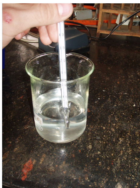
Měření teploty vody lihovým teploměrem
